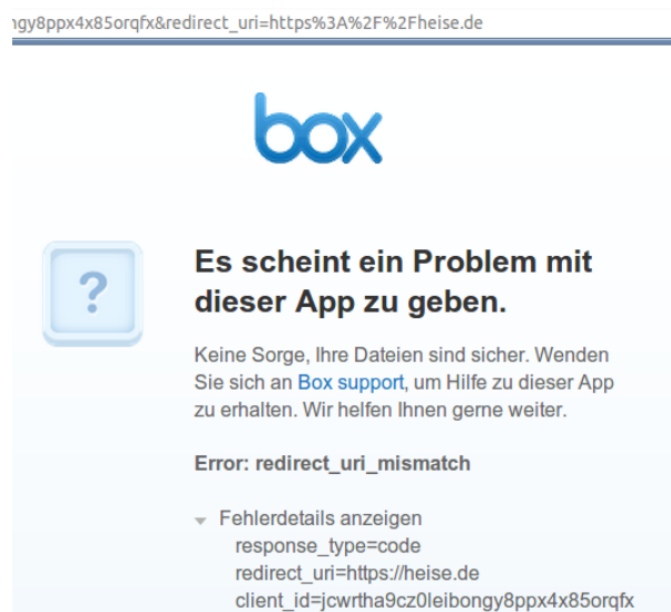
Abbildung 5.2.: Verhalten des Anbieters Box bei Änderung des Redirection URI Parameters
